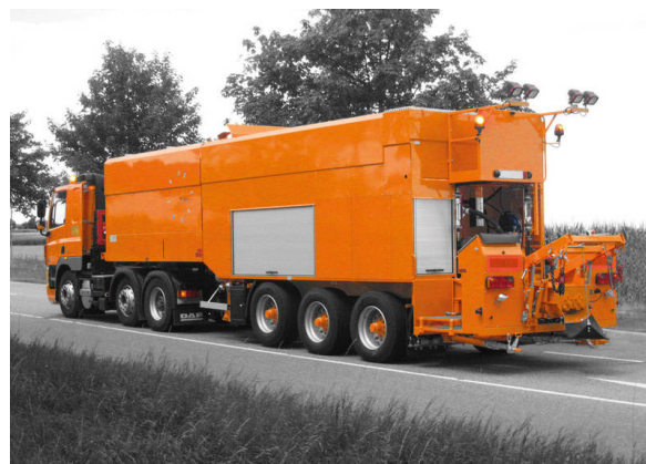
Рис. 5. Машина для укладки тонкослойных покрытий SCHÄFER, модель SMS
